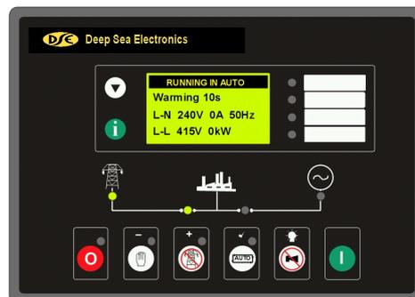
\* Параметры сети: напряжение, частота, активная и полная мощности.
