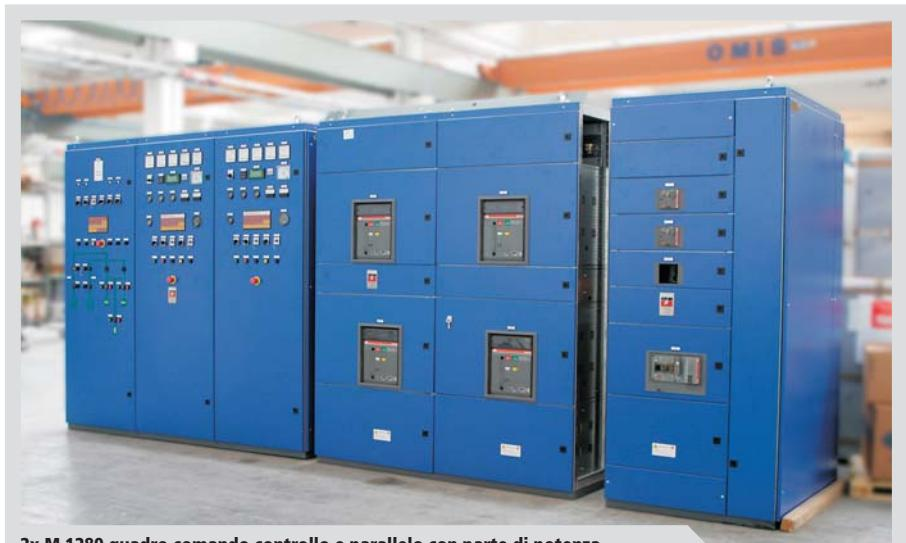
**2x M 1280 quadro comando controllo e parallelo con parte di potenza**
